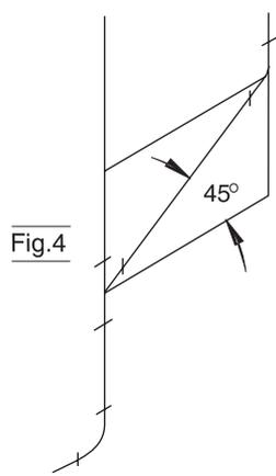
Os tubos fora da horizontal ou vertical são representados por traços com inclinação diferente de 30°, devendo-se marcar no desenho o ângulo real da inclinação do tubo (fig. 3 e 4).
